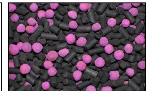
Aktivkohle/BAC / Activated carbon/BAC
