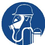
Umgebungsluftunabhängiges Atemschutzgerät tragen.
