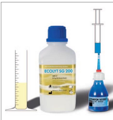
Messen Sie das Goldbad ECOLYT SG200 mit dem im Starter-Kit enthaltenen Messzylinder ab und füllen Sie dieses in das passende Becherglas. Verwenden Sie zur Dosierung des ACTIVATOR SG200 die mitgelieferte 5ml-Spritze (Art.-Nr. 77953455) und fügen Sie den ACTIVATOR SG200 dem dosierten Goldbad im Becherglas hinzu.
