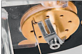
... das andere Ende des Drahts in eine der dafür vorgesehenen Bohrungen in die Magnethalterung der Halteklammer (Art.-Nr. 77953045) stecken.
