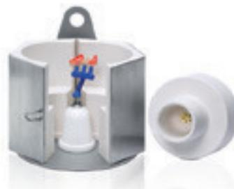
HiCAST ist völlig anders als bisher bekannte Gießgeräte. Das Schmelzen der Legierung basiert auf einem völlig neuartigen Konzept. Die Wasserkühlung dieses Hochfrequenz-Gießgeräts erfolgt über ein geschlossenes System, das aus dem integrierten 4-Litertank versorgt wird. Die Legierung wird direkt in einem Teil der Muffel geschmolzen und gegossen – separate Schmelzriegel sind passé!
